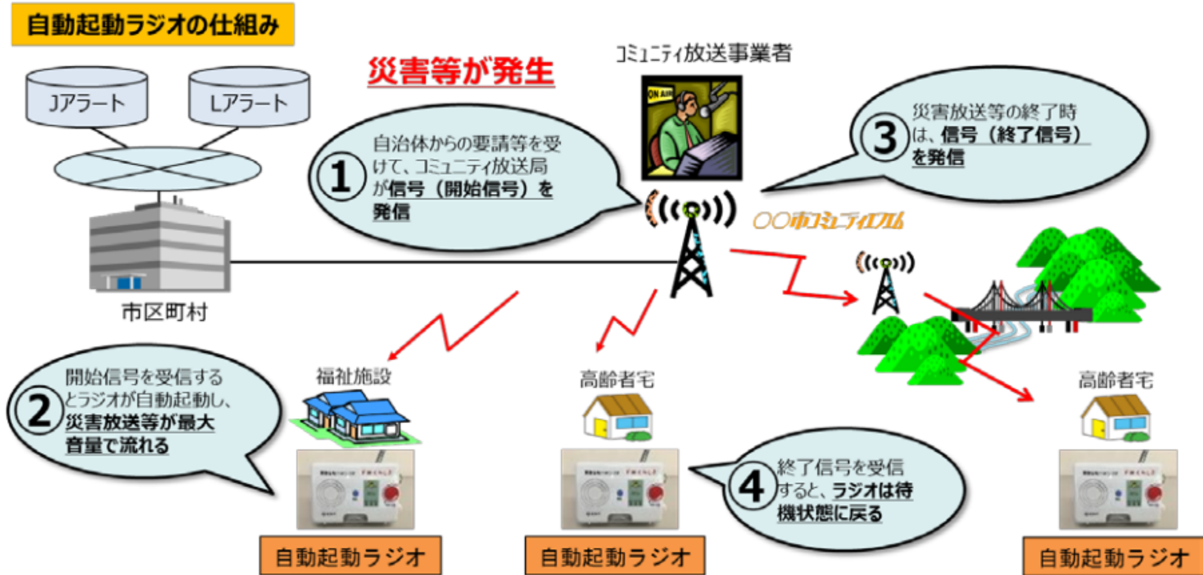
図 1.2.5 コミュニティ放送を活用した自動起動ラジオの仕組み
